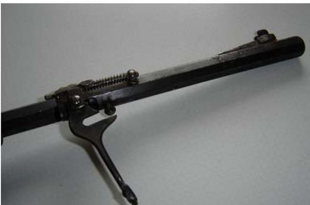
Über einen durch das Ziehen des Abzugs aktivierten Bolzen wurde das Pulver im Inneren der eingelegten Patrone gezündet.
