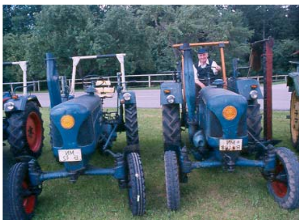
Lanz Typ 1616 und 2816, 28 bzw. 16 PS Bauj. 1956 und 1958, gekauft 1961 und 1965 mit diesen Bulldogs wurden die meisten Betriebsstunden geleistet.
